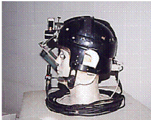
Figure 10. Le casque de l'oculomètre ASL utilisé dans le cadre de l'étude
