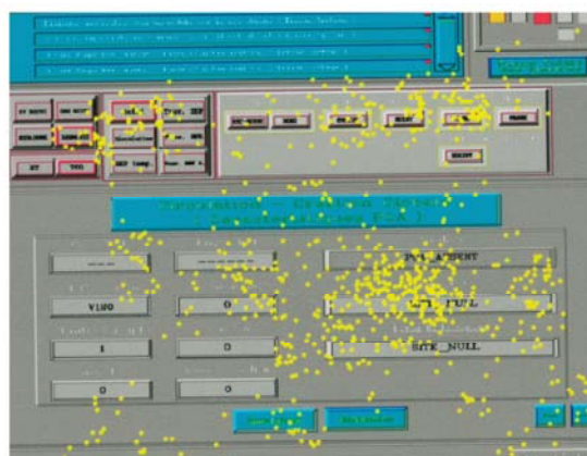
Figure 9. Extrait de résultat d'une évaluation exploitant un oculomètre
